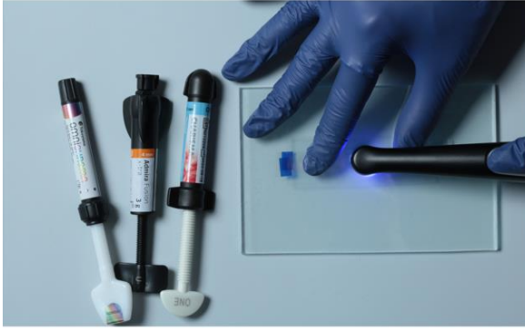
Şekil 24. Mikrosertlik ve polimerizasyon derecesini değerlendirmek amacıyla 63 yeni örneğin hazırlanması
