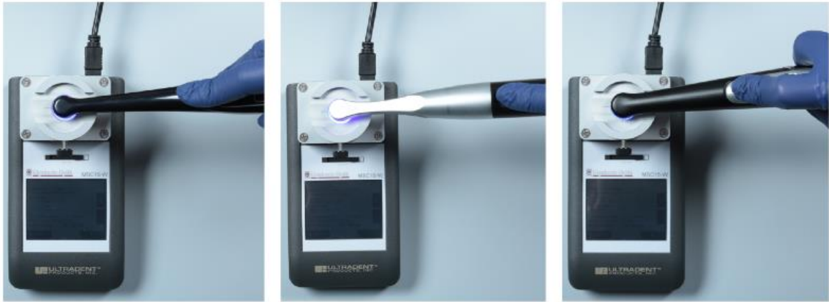
Şekil 19. Işık kaynaklarının ışık çıkış gücünün MSC15-W spektrometre ile ölçümü.
